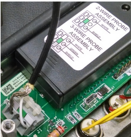
Figure 1 : Connexion des fils de la sonde
