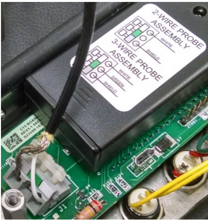
图1：探头组件引线连接
